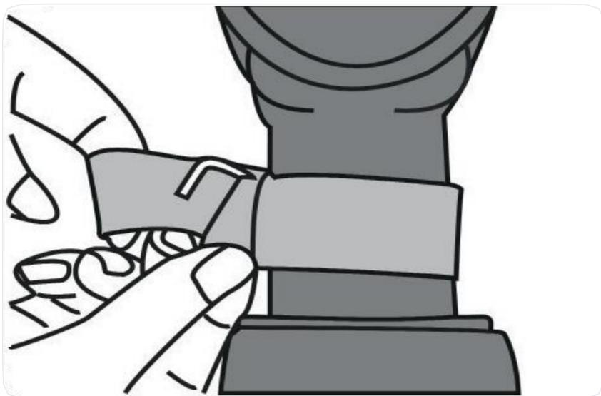
c. Legen Sie den Gurt um das kreisförmige Stück des Gehäuses, das sich direkt über den Entriegelungsclip befindet, und schieben Sie das Material dann durch den kleinen Spalt zwischen der silbernen Schnalle.
