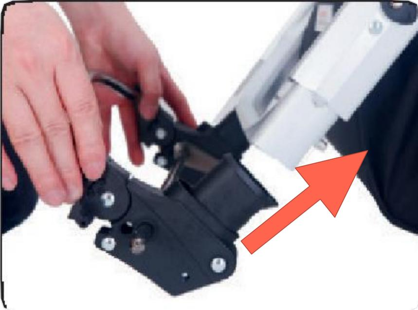
a. Stellen Sie sicher, dass das Fahrgestell ausgeklappt ist, bevor Sie die Bremsstange und die Räder montieren. Befestigen Sie die Bremsstange an der Rückseite des Fahrgestells wie oben gezeigt.
