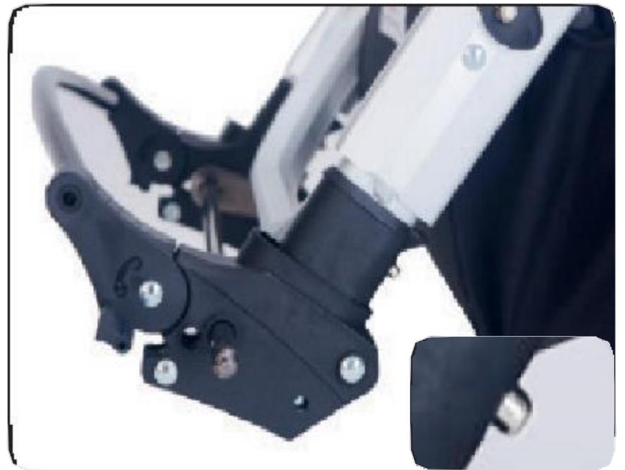
b. Vergewissern Sie sich, dass die silbernen Verriegelungsclips auf jeder Seite sichtbar sind, und prüfen Sie dies, indem Sie die Bremsstange nach dem Einbau nach unten ziehen.
