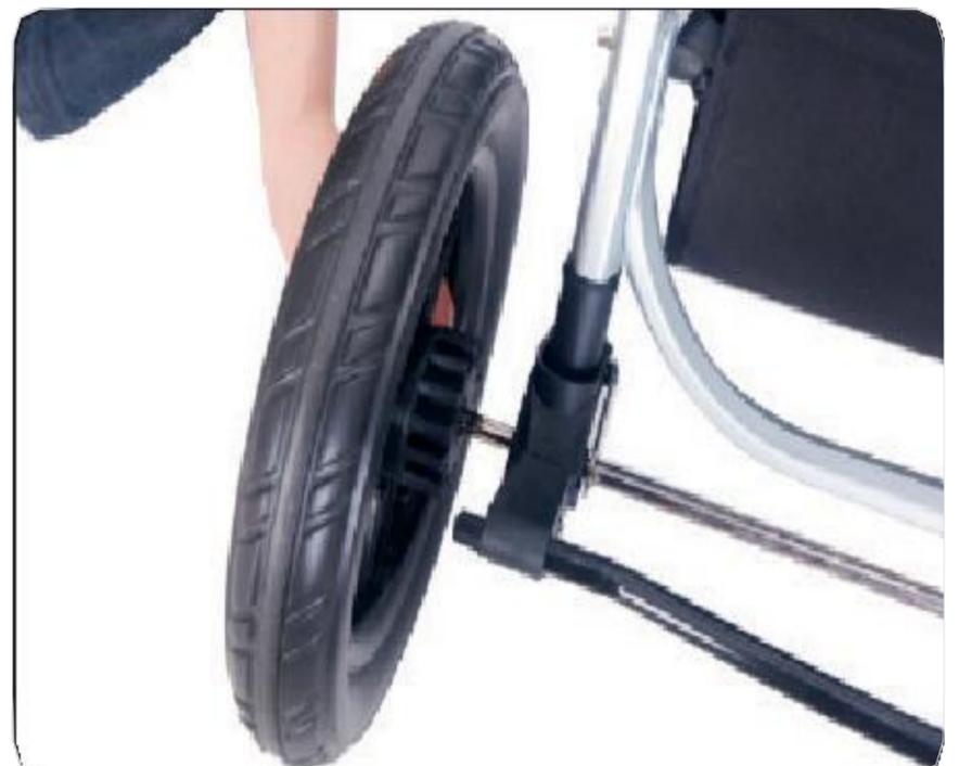
Um die Räder zu demontieren, drücken Sie den mittleren Knopf und ziehen Sie.
