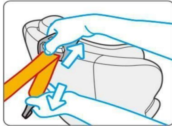
Ziehen Sie das obere Halteband heraus und drücken Sie den Entriegelungsknopf des Haltegurts, um den Gurt zu verlängern, bis er lang genug ist, um die benutzerfertige Halteverankerung dahinter einzuhängen.
