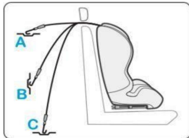
Accrochez le crochet de la sangle d'attache aux ancrages prêts à l'emploi. Vérifiez qu'il y a peut-être 3 ancrages pour le crochet, veuillez en trouver un en votre faveur.
