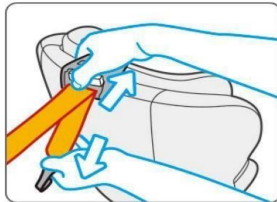
Retirez la sangle supérieure et appuyez sur le bouton de déverrouillage de la sangle d'attache pour étendre la sangle jusqu'à ce qu'elle soit suffisamment longue pour accrocher l'ancrage d'attache prêt à l'emploi derrière.
