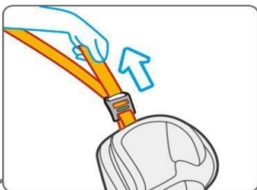
Tirez la sangle d'attache sur une autre extrémité vers l'arrière pour serrer l'attache supérieure
