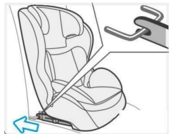
Saisissez le corps du siège pour vérifier s'il est bien attaché ou s'il tremble. Si le siège tremble et que les connecteurs ISO FIX sont retirés, répétez les étapes ci-dessus et réinstallez-le.
