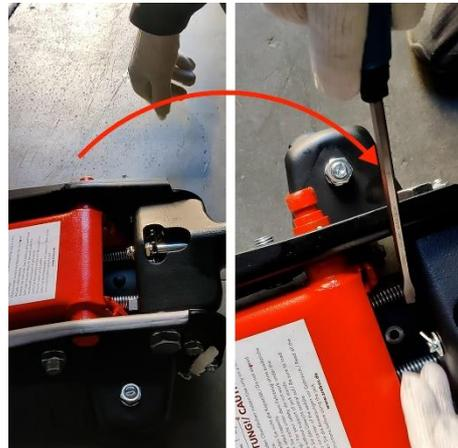
3. Füllen Sie Hydrauliköl nach und pumpen Sie mit dem Griff einige Male, um überschüssige Luft abzulassen
