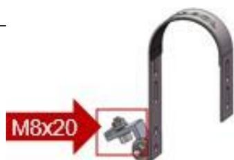
Antes de comenzar el montaje, retire el perno premontado M8x20 del gancho. Déjalo a un lado para el siguiente paso.
