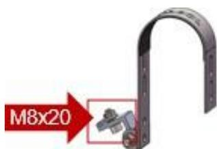
Antes de comenzar el montaje, retire el tornillo premontado M8x20 del gancho. Déjelos a un lado.
