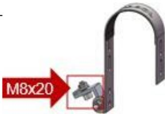
Avant de commencer l'assemblage, veuillez retirer le boulon pré-assemblé M8x20 du crochet. Mettez-le de côté pour l'étape suivante.
