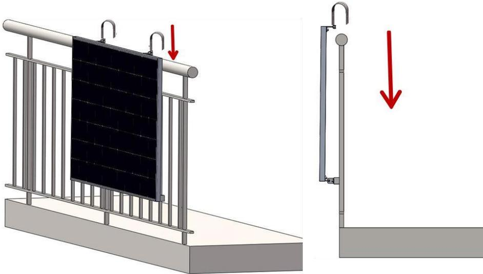
Appendere il sistema completo alla ringhiera del balcone, quindi fissarlo con la vite M8x100 (S2)
