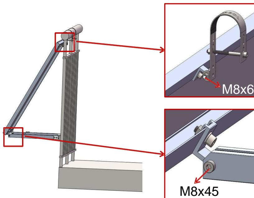
Quindi, collegare la guida di montaggio (C) alla ringhiera del balcone con bullone M8x80 (S2) e serrarla.
