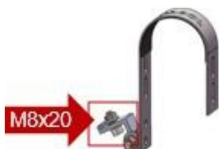
Prima di iniziare il montaggio, rimuovere la vite preassemblata M8x20 dal gancio. Metteteli da parte.
