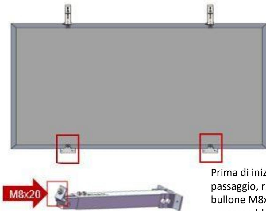
Installare la staffa di prolunga (D) sul telaio posteriore del pannello solare come descritto di seguito.
