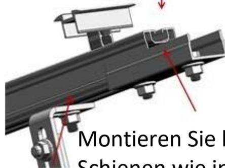
Montieren Sie beide Schienen wie in der Abbildung, verwenden Sie dafür die M10\*20 Schrauben und M10 Muttern
