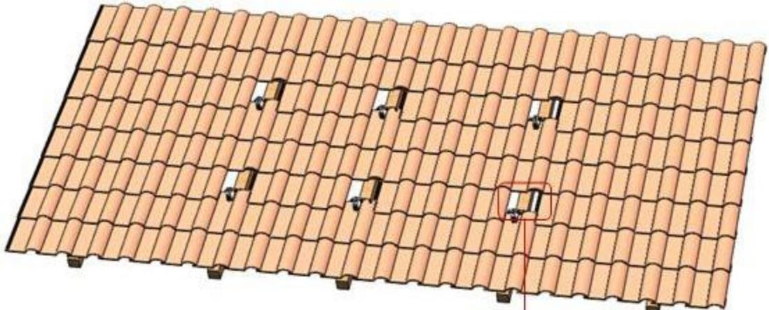
Use tornillos de madera para fijar la base al listón.
