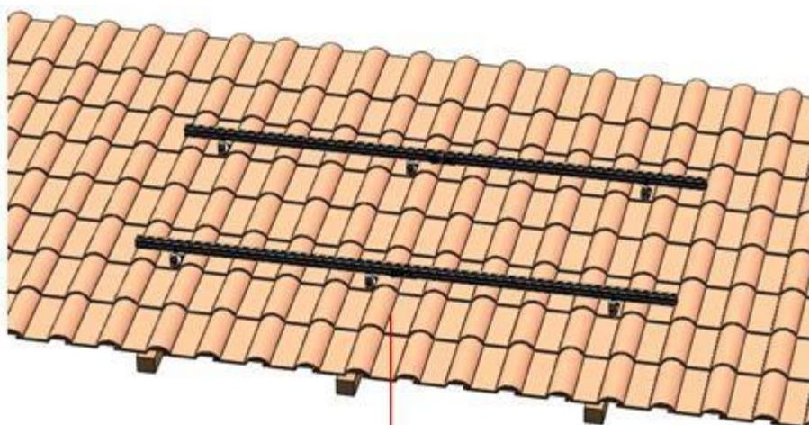
Conecte los rieles al perno M10 \* 20 y la tuerca M10 como se muestra en la imagen
