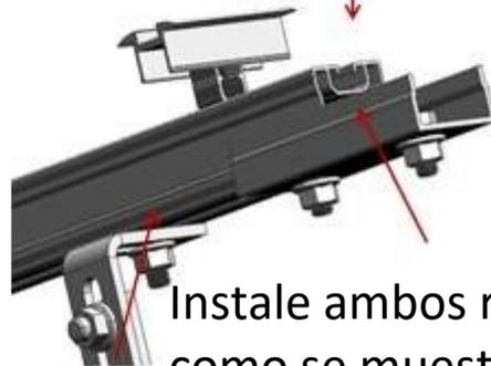
Instale ambos rieles como se muestra en la figura, utilizando los tornillos M10 \* 20 y las tuercas M10
