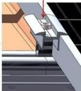
Fije la abrazadera en el riel con el tornillo M8 \* 2.5
