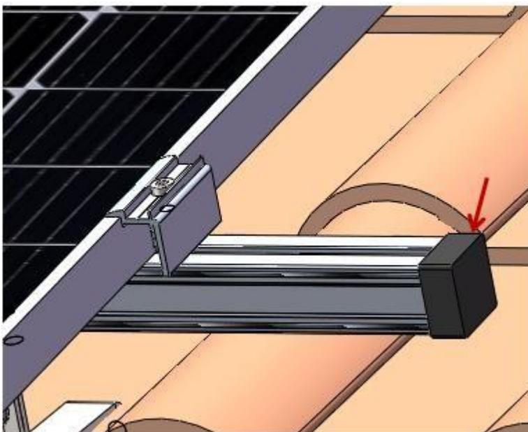
Coloque las tapas de los extremos después del montaje
