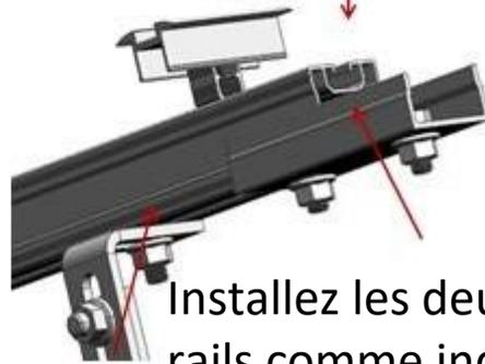
Installez les deux rails comme indiqué sur la figure, à l'aide des vis M10\*20 et des écrous M10
