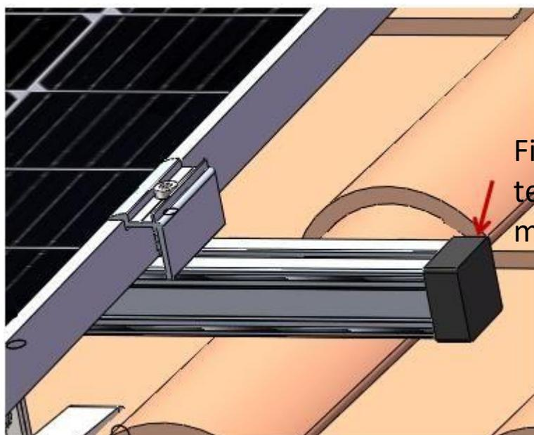
Fissare i tappi terminali dopo il montaggio
