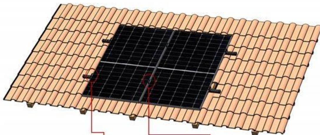
Fissare il morsetto interno alla guida con la vite M8 \* 42.5
