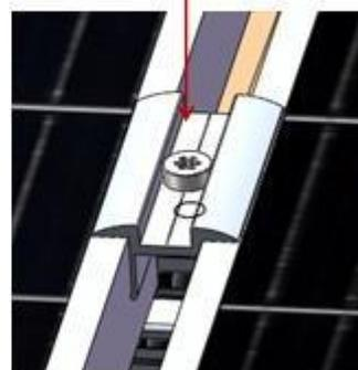
Fissare il morsetto nella guida con la vite M8 \* 2.5
