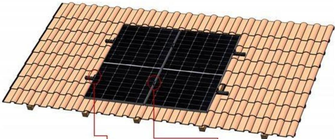
Pripevnite vnútornú svorku na koľajnicu pomocou skrutky M8 \* 42.5
