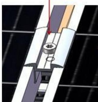
Upevnite svorku v koľajnici pomocou skrutky M8\*2.5
