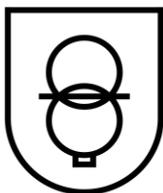
Sicherheitstransformator - kurzschlussfest. Ausgangsspannung bis höchstens 50 Volt
