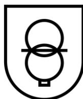
Transformador de seguridad: a prueba de cortocircuitos. Tensión de salida hasta un máximo de 50 voltios
