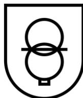
Trasformatore di sicurezza - a prova di cortocircuito. Tensione di uscita fino a un massimo di 50 volt
