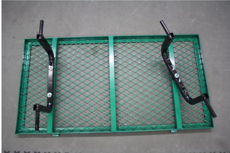
Abbildung 2: links Starachse; rechts Lenkachse
