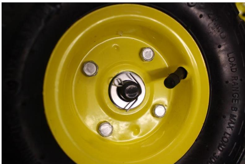
Illustrazione 3: Assemblaggio delle ruote
