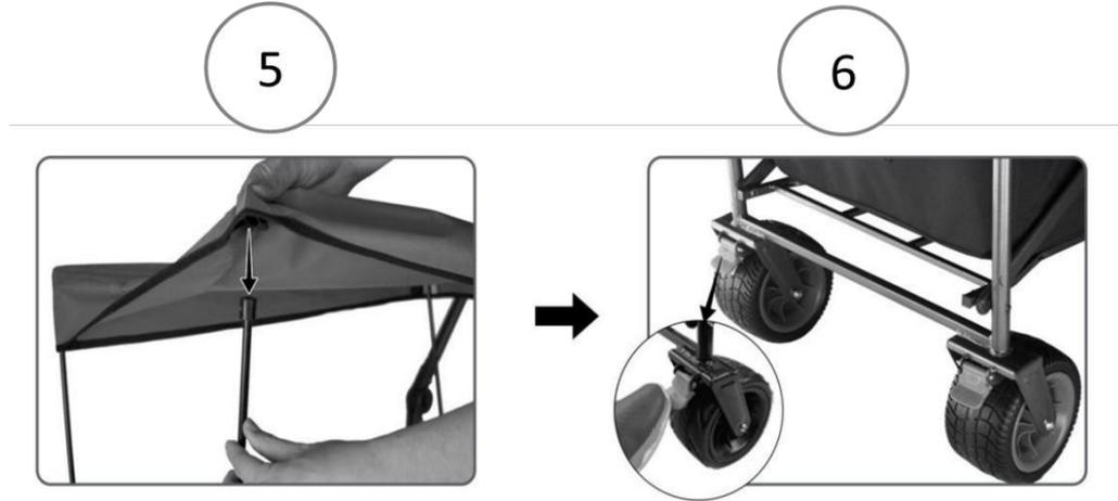
Paso 5: Monta la capota sobre las barras de soporte.
