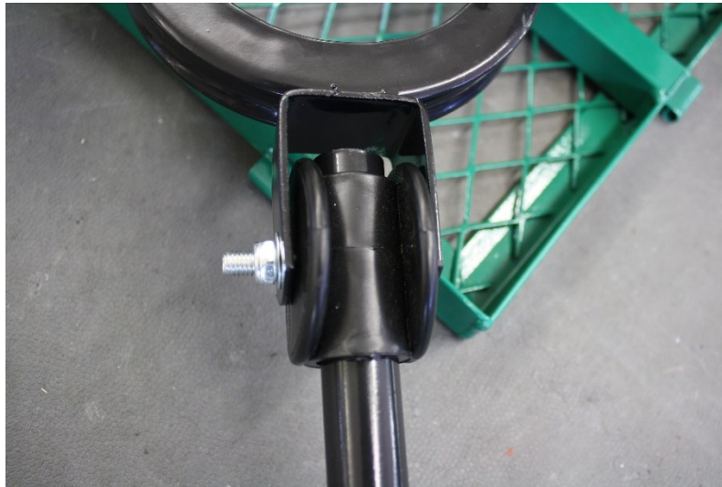
Figur 4: Montering af håndtaget
