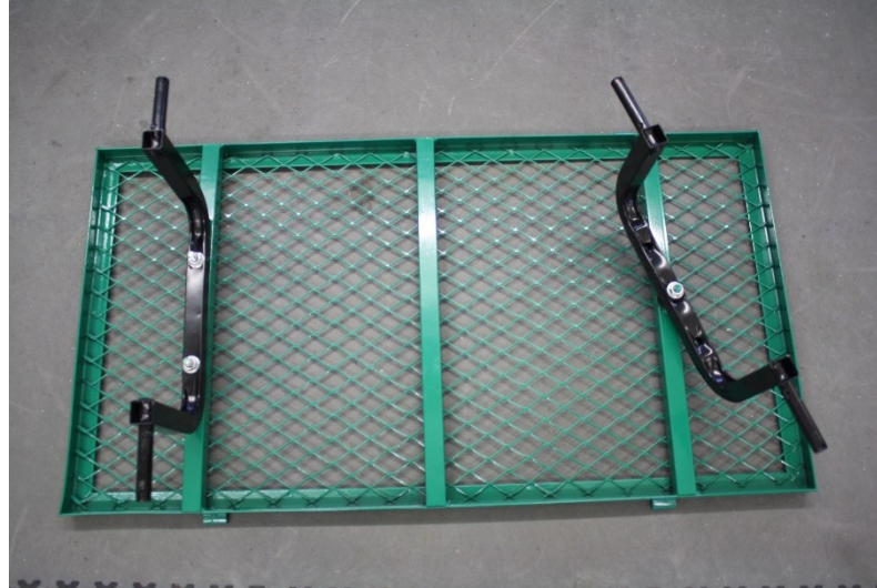
Figur 2: Venstre stiv aksel; højre styreaksel
