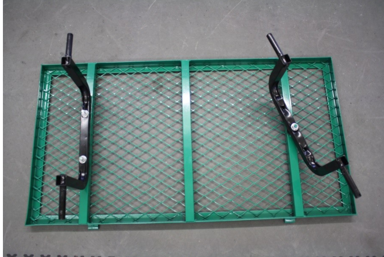
Figur 2: Vänster stel axel; höger styraxel
