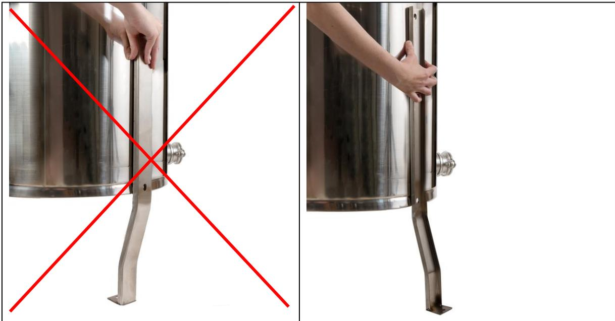
Für die unteren Befestigungen nutzen Sie bitte die längeren Schrauben ohne O-Ringe (6.3). Führen Sie die lange Schraube durch die vorgesehene untere Aussparung. Stecken Sie die Schraube von innen (durch die Kesselwand hindurch) durch das Loch. Stecken Sie danach die gezackte Unterlegscheibe (6.2) auf. Schrauben Sie zuletzt die schwarzen Flügelschrauben (6.1) fest.
