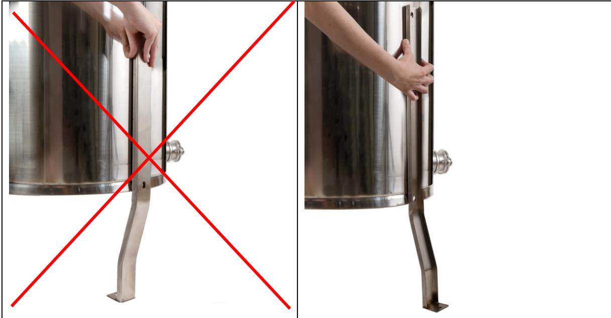
Pour les fixations inférieures, utiliser les vis plus longues sans joints toriques (6.3). Insérez la vis longue dans l'évidement inférieur prévu à cet effet. Insérer la vis de l'intérieur (à travers la paroi de la chaudière) à travers le trou. Insérez ensuite la rondelle dentelée (6.2). Serrez enfin les vis à ailettes noires (6.1).
