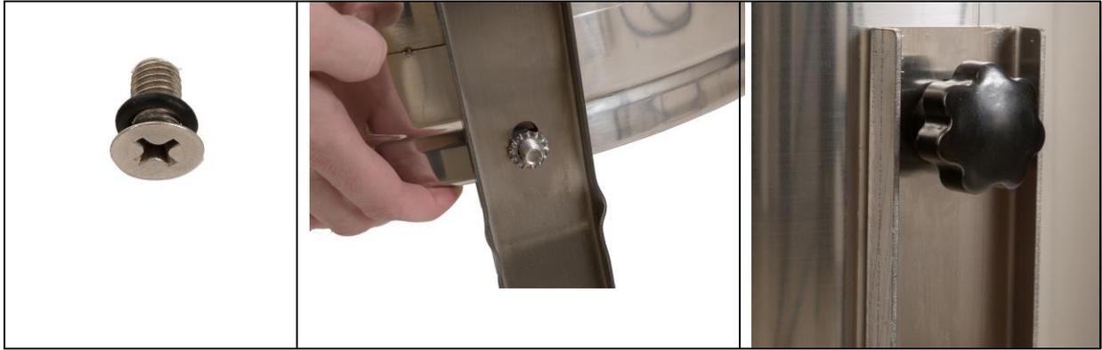
Pour monter l'orifice de sortie du miel, retirez l'écrou de la pièce de sortie. Insérez le bec dans le trou sur le devant et fixez l'arrière avec l'écrou (assez serré pour sceller le joint torique).
