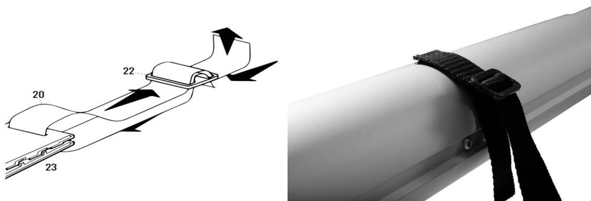
7. Lösen Sie die acht Klettaufkleber "21" vom Klebeband "20" und ziehen Sie die Schutzschichten ab. Kleben Sie diese - in einer geraden Linie in gleichem Abstand - über die Länge X auf die Rohre. Halten Sie einen Sicherheitsabstand von den beiden Rohrenden von 30 cm ein!
