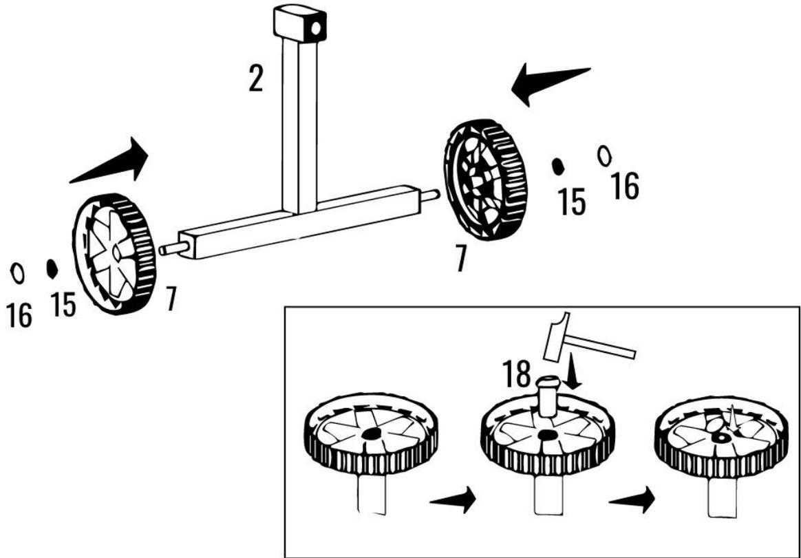
Toccare l'anello di ritenuta sul portaruota con un martello e l'utensile in dotazione. Quindi il cappuccio di copertura nero deve essere indossato.
