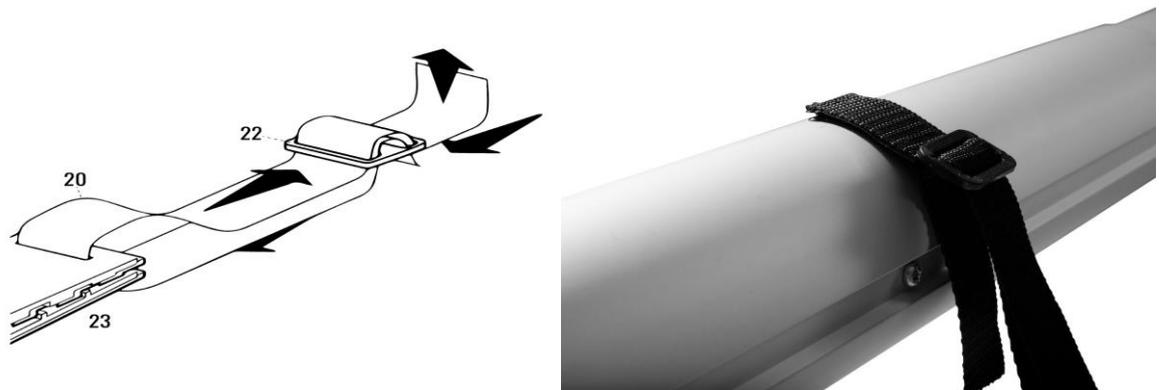
7. Staccare gli otto adesivi Velcro "21" dal nastro adesivo "20" e staccare gli strati protettivi. Incollarli - in linea retta a una distanza uguale - sulla lunghezza X ai tubi. Mantenere una distanza di sicurezza di 30 cm dalle due estremità del tubo!
