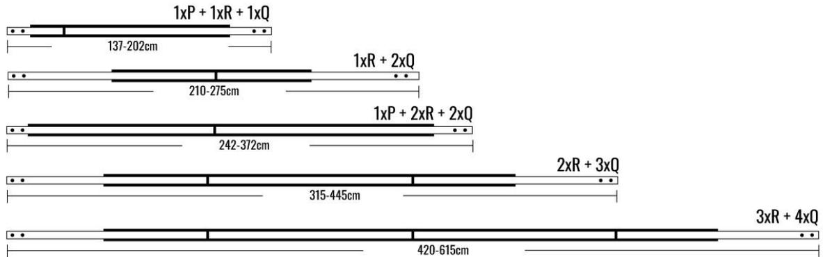
Hinweis: Die Löcher an den Rohren P oder Q sollten an beiden Enden der kompletten Rohrkonfiguration positioniert werden, damit sie an den Rollenhaltern A und B montiert werden können.
