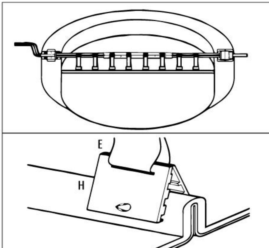
13. Um das Solarspulensystem zu entfernen, schieben Sie A von J und schwenken Sie den Rollenhalter um den Pool herum. Stellen Sie sicher, dass die Rohrhalterung auf der Leiste ruht oder entfernen Sie sie vollständig.
