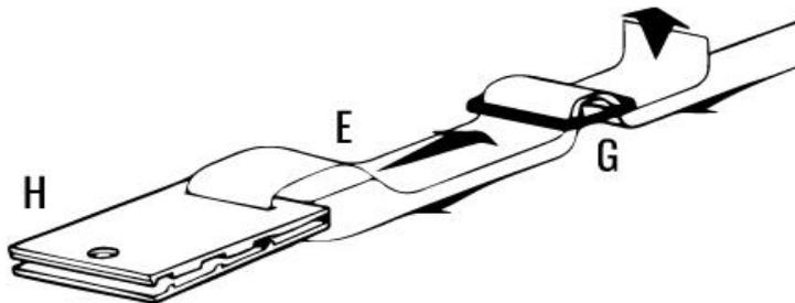
10. Lösen Sie die 8 Klettaufkleber F von E und ziehen Sie die Schutzschichten ab. Kleben Sie diese - in einer geraden Linie in gleichem Abstand - über die Länge Y auf die Rohre. Halten Sie einen Sicherheitsabstand von den beiden Rohrenden von 15 cm ein!
