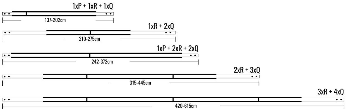
Nota: Los orificios de los tubos hexagonales ( P o Q) deben colocarse en ambos extremos de la configuración completa del tubo de modo que puedan montarse en los soportes de rodillos (A y B).
