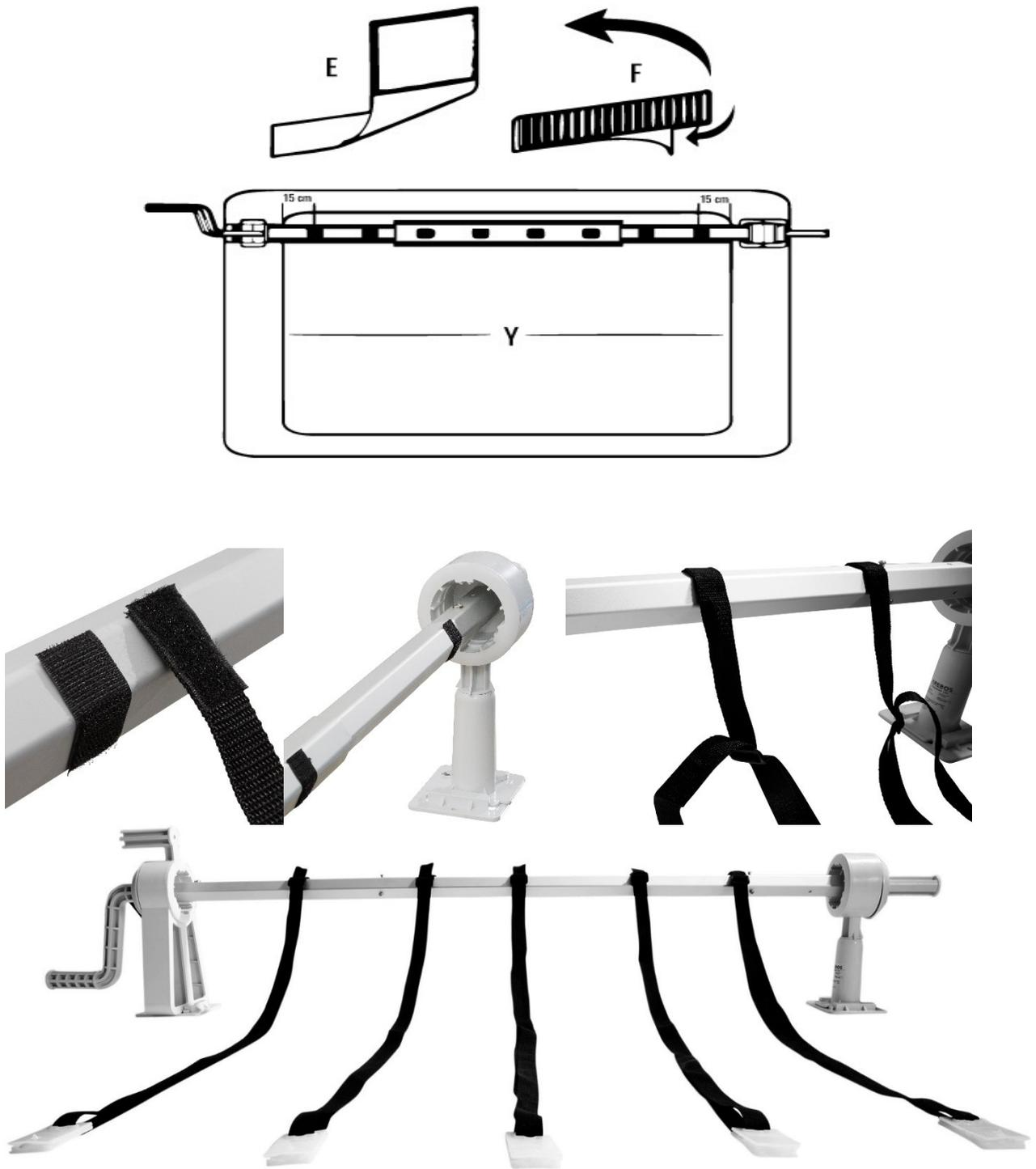
11. Para piscinas rectangulares sobre el suelo, abra la cubierta sobre la piscina y colóquela en su posición. Fije los clips de cubierta (H) a la cubierta, manteniendo los mismos intervalos regulares que las Velcro pegatinas en los tubos (ver 10.). Asegúrese de que la longitud de la correa Velcro permita que la cubierta quede plana sobre la piscina para que no pueda pasar viento debajo de la cubierta.
