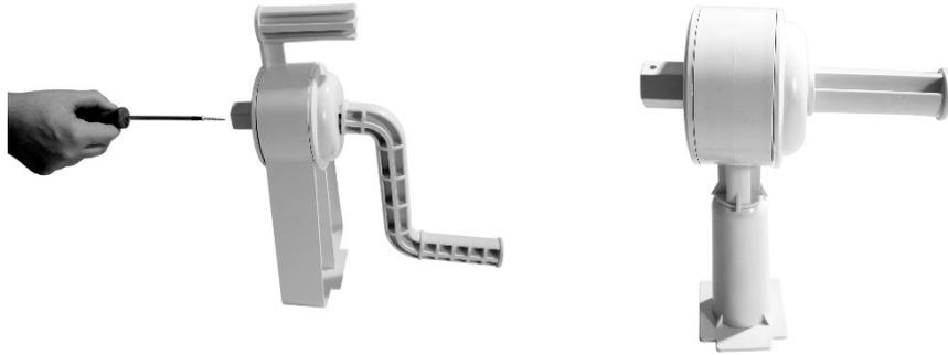
2. Atornille los tornillos roscados (L) en los asientos 1 y 2 (A y B) del carrete y apriete los tornillos.
