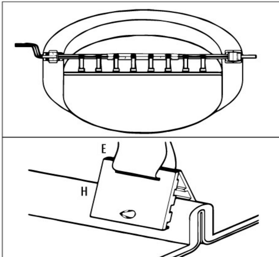
13. Para retirar el sistema de bobina solar, deslice el asiento del carrete (A ) de la placa inferior (J) y gire el asiento del carrete alrededor de la piscina. Asegúrese de que el soporte de la tubería descansa sobre la repisa o retírelo por completo.
