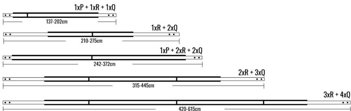
Nota: I fori sui tubi esagonali ( P o Q) devono essere posizionati su entrambe le estremità della configurazione completa del tubo in modo che possano essere montati sulle staffe dei rulli (A e B).
