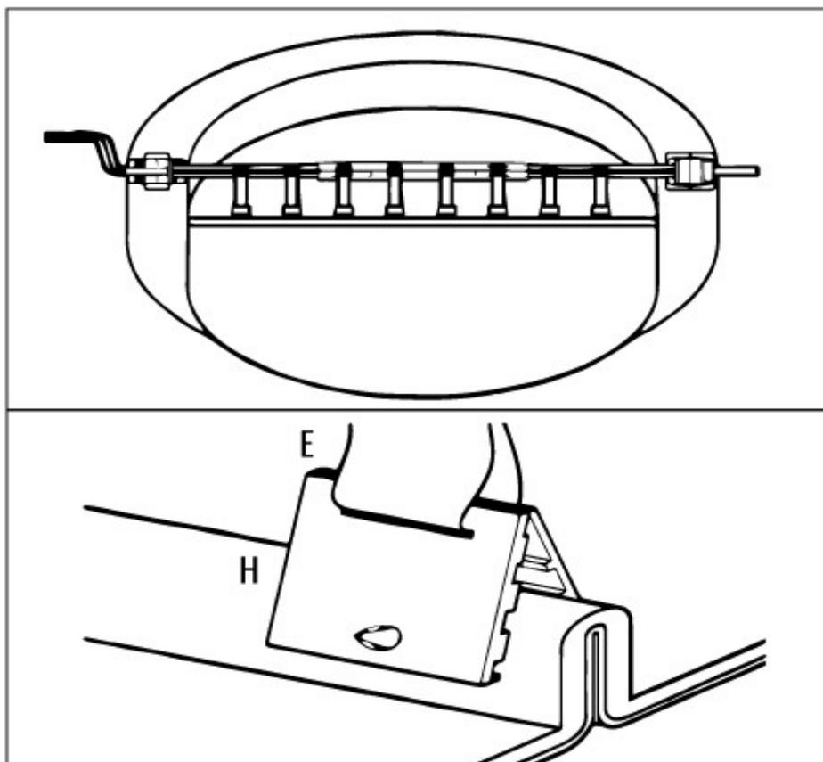
13. Per rimuovere il sistema di bobine solari, far scorrere il portamulinello (A) dalla piastra inferiore (J) e ruotare il portamulinello intorno alla piscina. Assicurarsi che il supporto del tubo poggia sulla sporgenza o rimuoverlo completamente.
