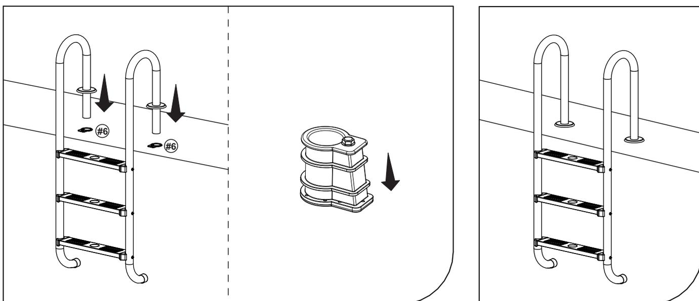
3. Nachdem die Poolleiter komplett zusammengebaut wurde, diese ebenerdig hinter dem Beckenrand einzementieren. Dabei spielt die Platzierung eine wichtige Rolle. Bei weit ausladenden bzw. eng ausladenden Einstiegsleitern muss dementsprechender Abstand gewährleistet sein.
