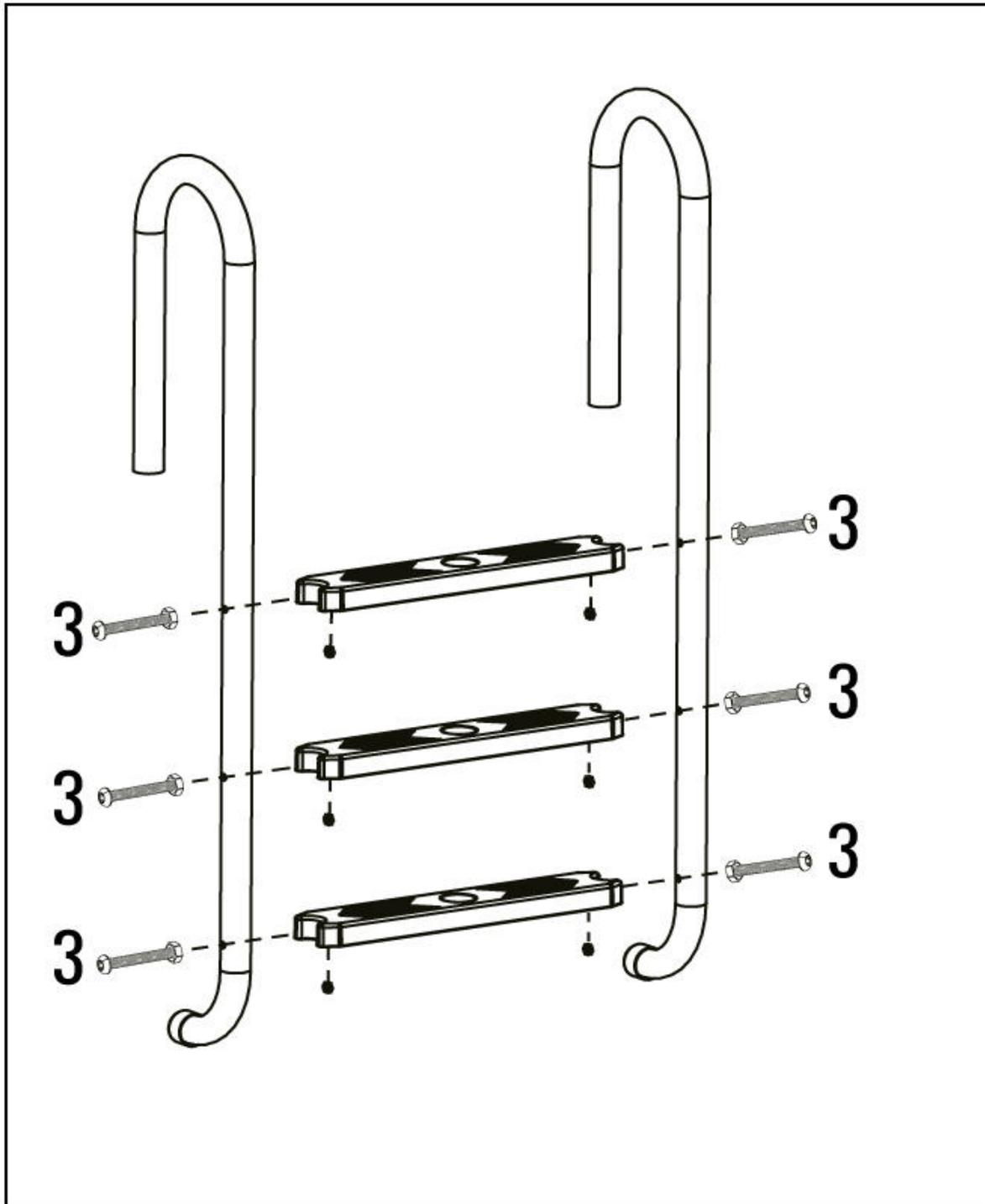
2.1 Installationsschritt bei Verwendung von #5, #7 und #8 Ersatzteilen.
