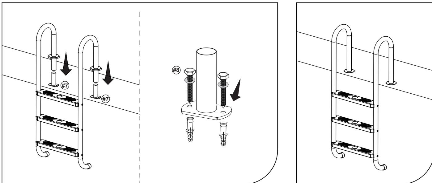
2.2 Installationsschritt bei Verwendung von Ersatzteilen Nr. 5 und Nr. 6.
