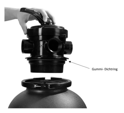
b) Setzen Sie das Ventil auf den Tank. Installieren Sie die Flanschklemme um den Tank und den Ventilflansch. Ziehen Sie das Ventil gerade so fest an, dass es zum endgültigen Aufstellen am Tank gedreht werden kann.
