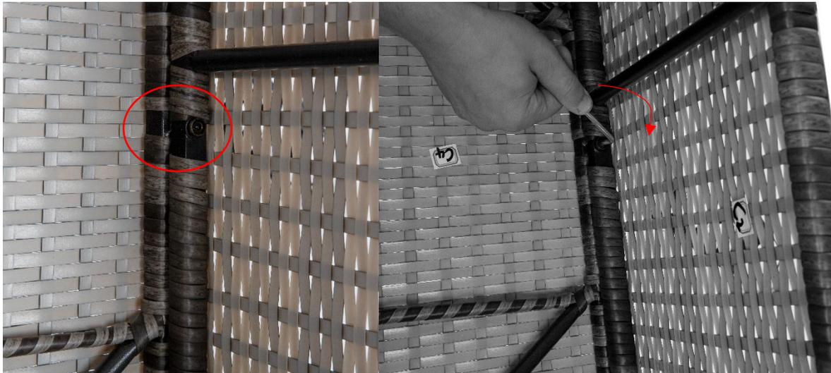
**Tornillos medianos:** Estos tornillos se sujetan con dos arandelas (una por lado) y una tuerca (ver imagen). Apriete el tornillo y sostenga la llave contra él.
