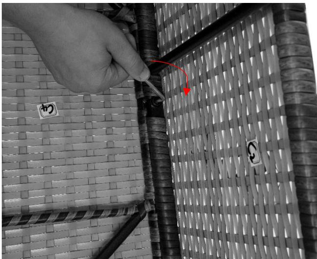
**Mittlere Schrauben:** Diese Schrauben werden mit zwei Unterlegscheiben (eine pro Seite) und einer Mutter (siehe Bild) befestigt. Ziehen Sie die Schraube fest und halten Sie mit dem Maulschlüssel gegen.
