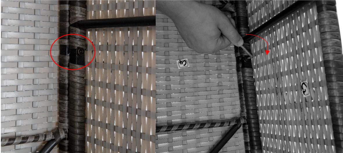
**Tornillos medianos:** Estos tornillos se sujetan con dos arandelas (una por lado) y una tuerca (ver imagen). Apriete el tornillo y sosténgalo contra él con la llave de extremo abierto.
