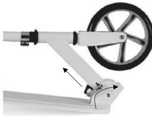
Stellen Sie sicher, dass der Tretroller komplett entfalten ist durch Hören eines „Einschnappens“. Schließen Sie den Schnellöffner. Stellen Sie sicher, dass er fest sitzt.
