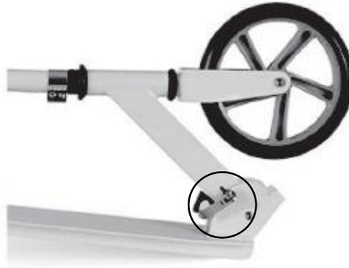
Durch Ziehen des Auslösers, können Sie den Tretroller ausklappen.
