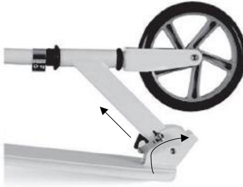
Asegúrese de que el scooter esté completamente desplegado escuchando un "chasquido". Cierre el abrebotas. Asegúrate de que esté atascado.
