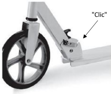
Al abrir el abrevapasto, puede ajustar el volante a una altura cómoda. Asegúrese de que la perilla encaje en el orificio de la columna de dirección. Después de configurar, cierre el abridor rápido.
