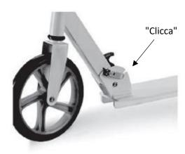
Aprendo l'apertura rapida, è possibile regolare il volante ad un'altezza confortevole. Assicurarsi che la manopola si agganci al foro del piantone dello sterzo. Dopo l'impostazione, chiudere l'apertura rapida.
