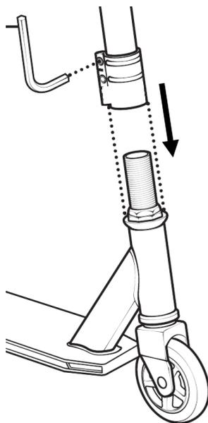
Apriete los tornillos de la abrazadera del manillar con una llave hexagonal hasta que el tubo de dirección ya no se tuerza o se deslice.
