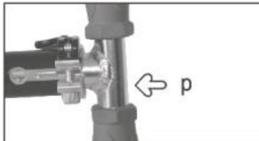
Il morsetto rapido può essere bloccato dopo aver chiuso l'aereo con la chiave a brugola sulla vite "k". Questa è la raccomandazione per l'uso più piccolo del maxi scooter (a prova di bambino!).
