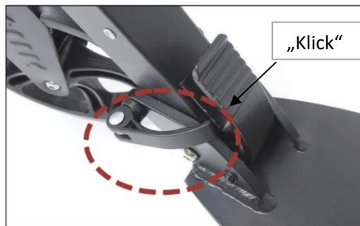
Stellen Sie sicher, dass der Tretroller komplett entfaltet ist durch Hören eines „Einschnappens“. Schließen Sie den Schnellöffner. Stellen Sie sicher, dass er festsitzt.
