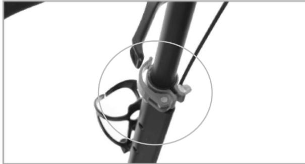
En ouvrant l'attache rapide, vous pouvez régler la direction à une hauteur confortable. Assurez-vous que le bouton s'enclenche dans un trou de la colonne de direction. Après le réglage, refermez le dispositif de dégageur rapide.
