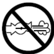
Verbot: Kompressor nicht einschalten, bevor der Druckluftschlauch angeschlossen ist.
