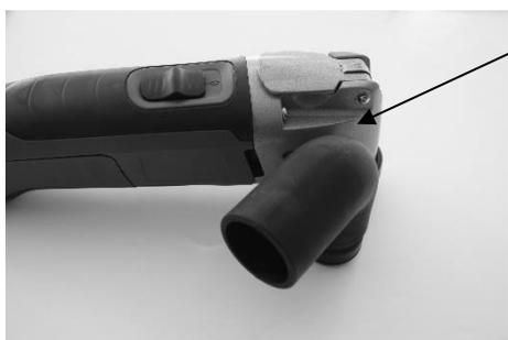
Coloque el tubo doblado contra el conector. Al utilizar esta conexión, el manillar debe estar conectado en el lado izquierdo. Cualquier limpiador industrial disponible en el mercado encajará en la conexión (diámetro interior de 35 mm).
