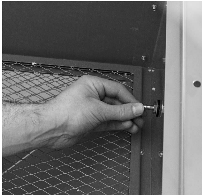
Obrázek 20: Přívod stlačeného vzduchu uvnitř
