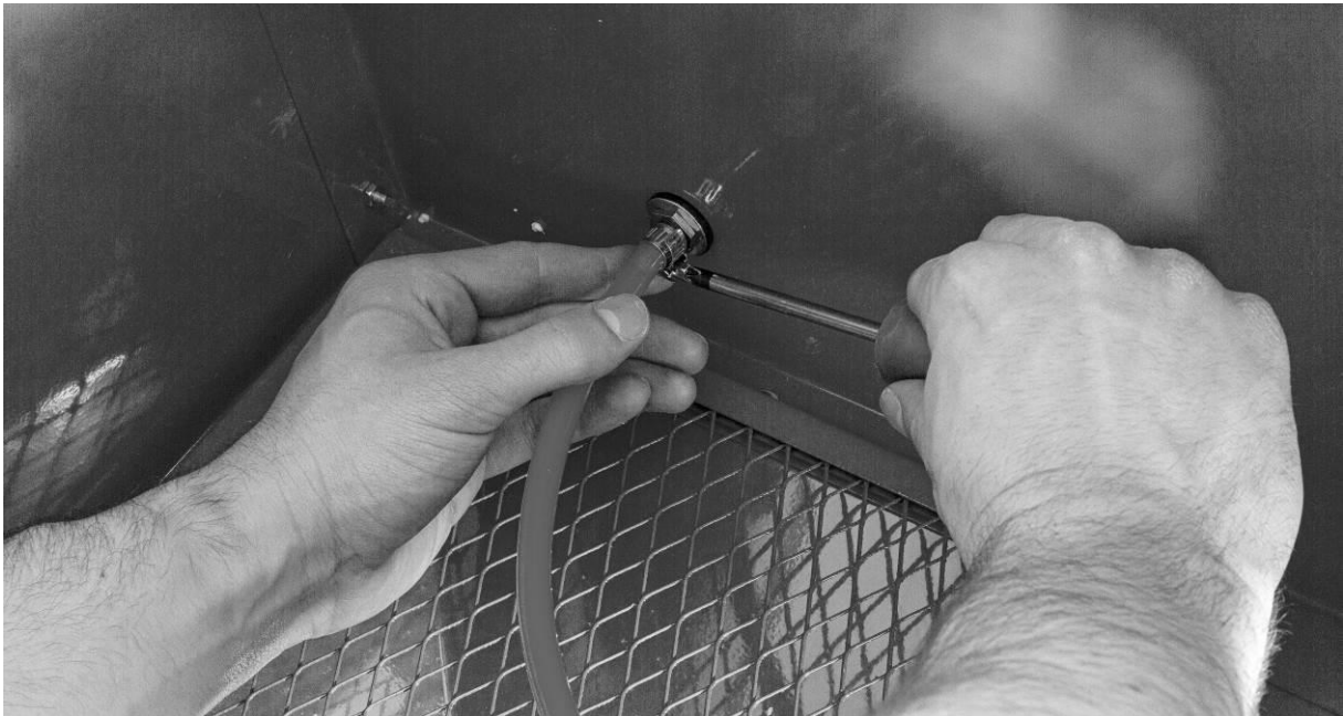
Obrázek 22: Připojení tenké hadice k přívodu stlačeného vzduchu uvnitř pískovací kabiny
