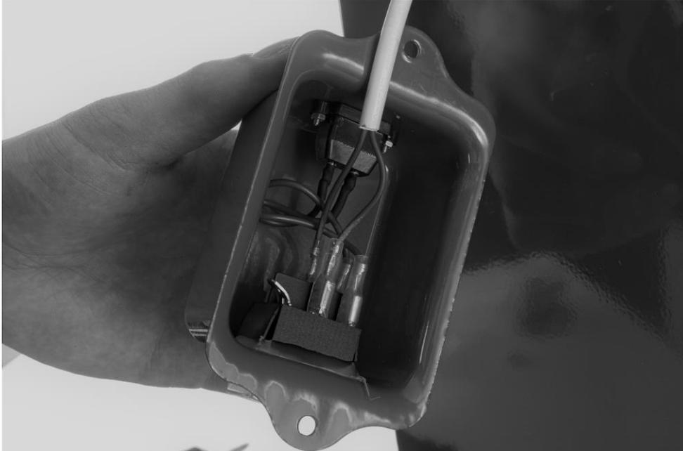
Abbildung 15: Anschluss Kabel an den Schalter
