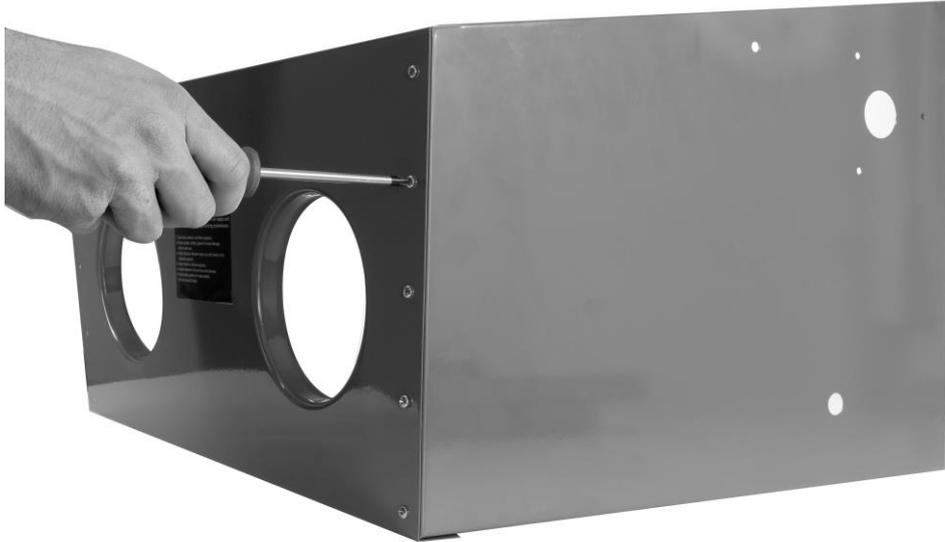
Abbildung 1: Befestigung der Seitenteile
