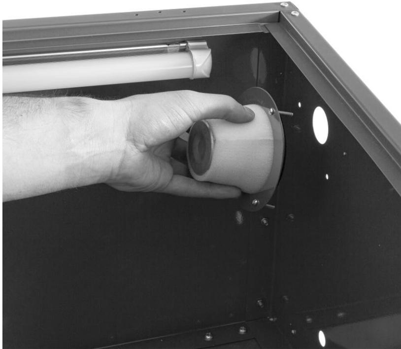
Abbildung 17: Montage des Schaumstofffilters
