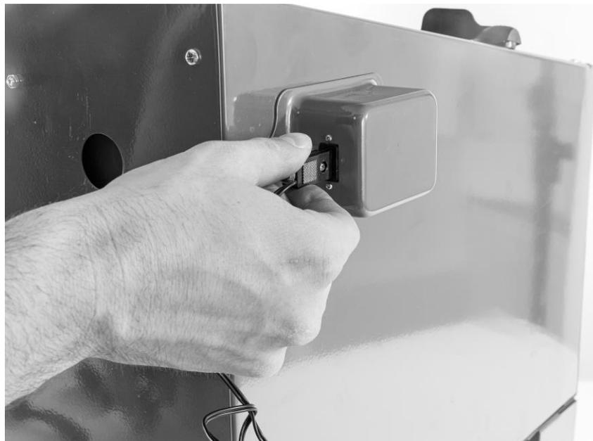
Abbildung 30: Stromanschluss
