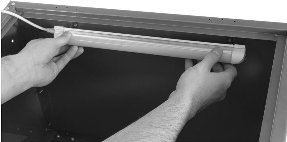
Abbildung 10: Montage Leuchtröhre
