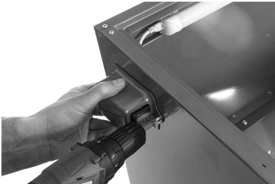
Abbildung 11: Demontage des Schaltkastens
