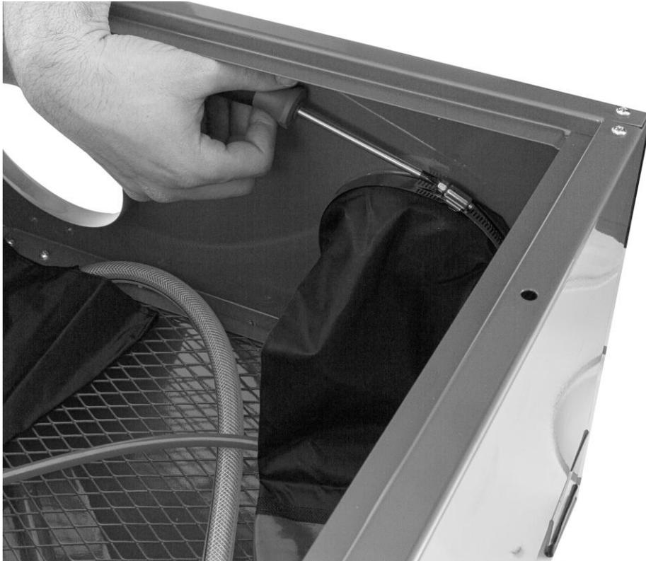
Abbildung 23: Befestigung der Handschuhe
