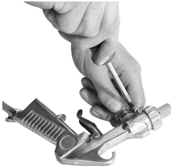
Abbildung 18: Befestigung des dicken Schlauches an der Sandstrahlpistole
