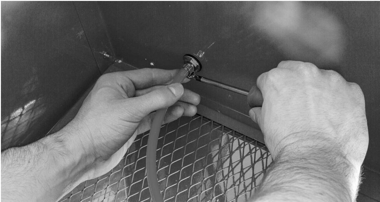
Abbildung 22: Befestigung des dünnen Schlauchs am Einlass der Druckluft im Inneren der Sandstrahlkabine
