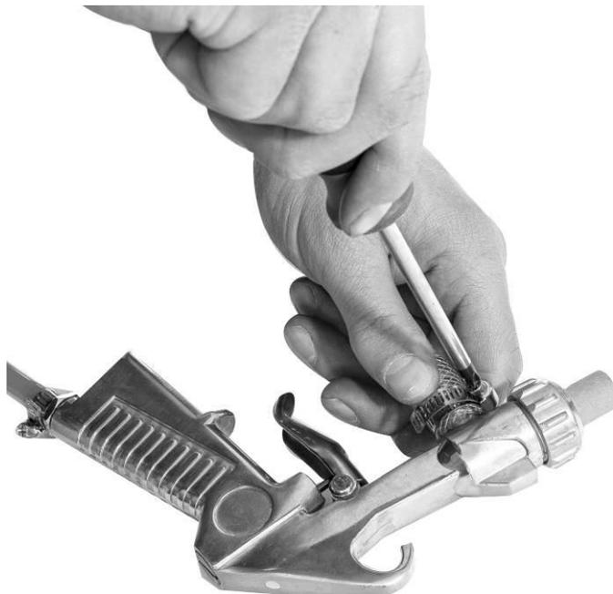
Figura 18: Fijación de la manguera gruesa a la pistola de chorro de arena
