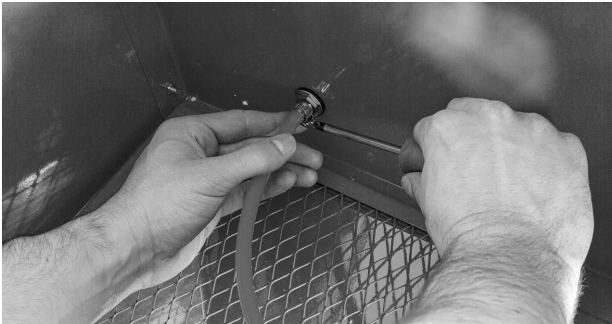
Figura 22: Fijación de la manguera delgada a la entrada del aire comprimido dentro de la cabina de chorro de arena
