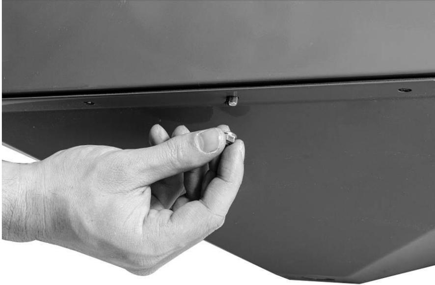
Figura 6: Fijación de la tuerca al fondo de la cabina de chorro de arena
