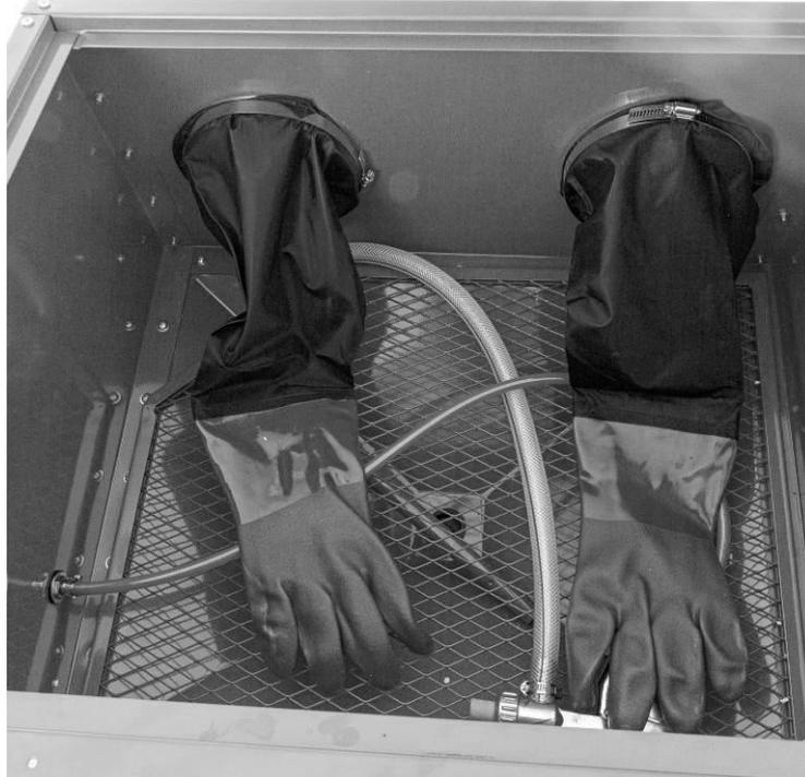
Figura 29: Posición correcta de la placa de rejilla
