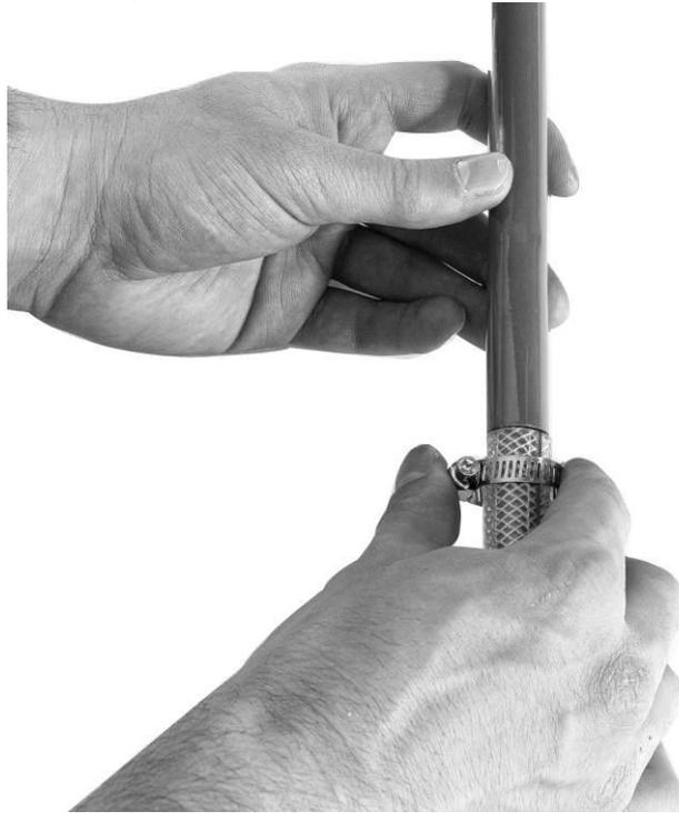
Figura 19: Fijación de la manguera gruesa a la tubería metálica
