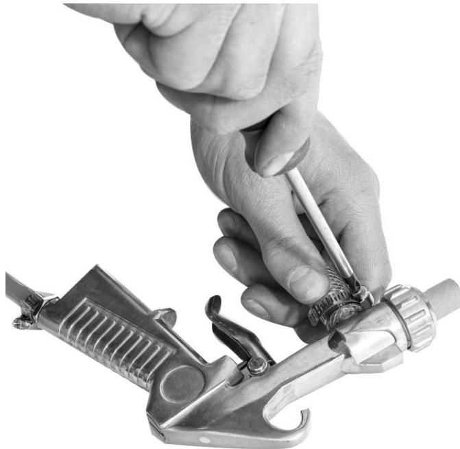
Figure 18 : Fixation du tuyau épais au pistolet de la cabine
