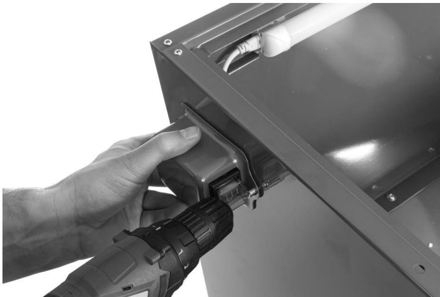
Figure 11 : Démontage de la boîte de coffrage
