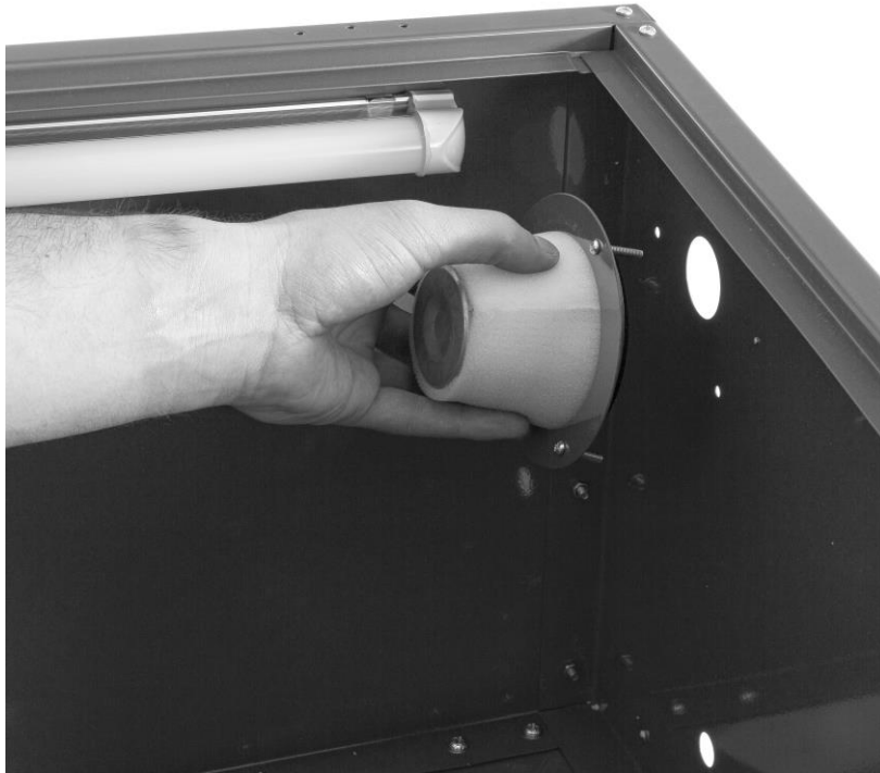
Figure 17 : Montage du filtre en mousse
