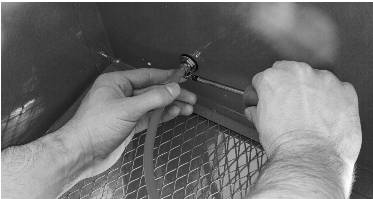
Figure 22 : Fixation du tuyau fin à l'entrée de l'air comprimé dans l'intérieur de la cabine de veine de sable.
