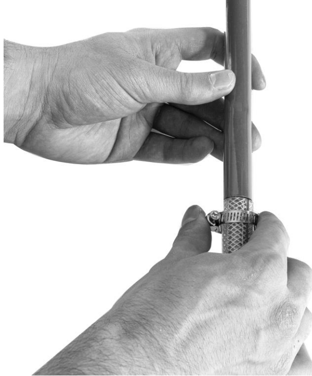
Figure 19 : Fixation du tuyau épais au tube métallique
