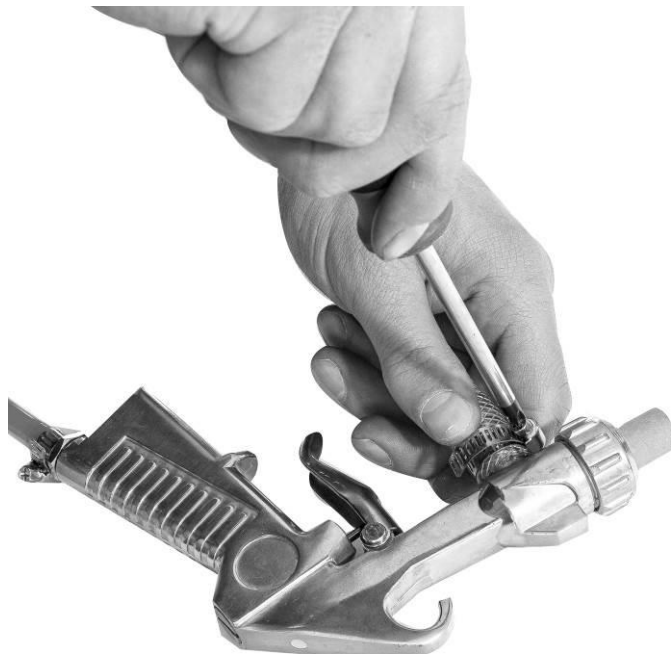
Figura 18: Fissaggio del tubo spesso alla pistola di sabbiatura
