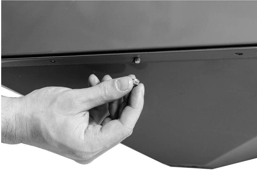
Figura 6: Fissaggio del dado al fondo della cabina di sabbiatura
