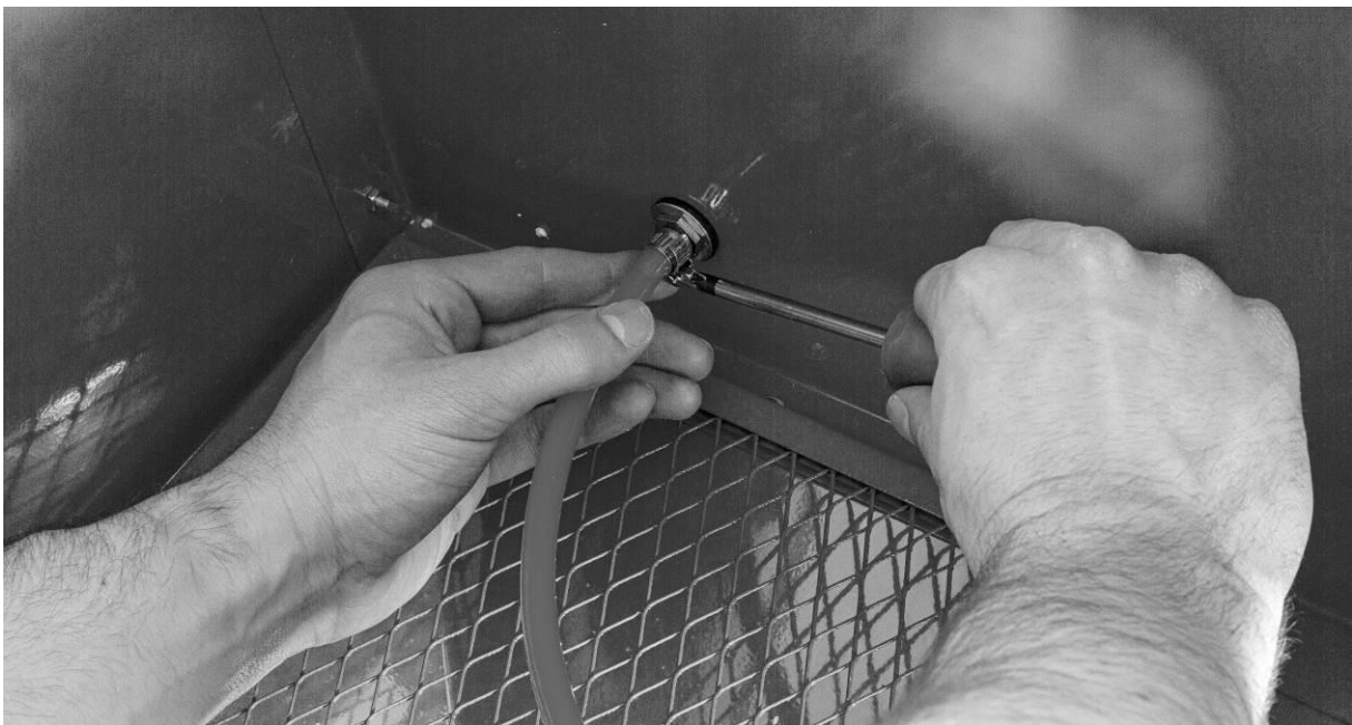
Figura 22: Fissaggio del tubo sottile all'ingresso dell'aria compressa all'interno della cabina di sabbiatura
