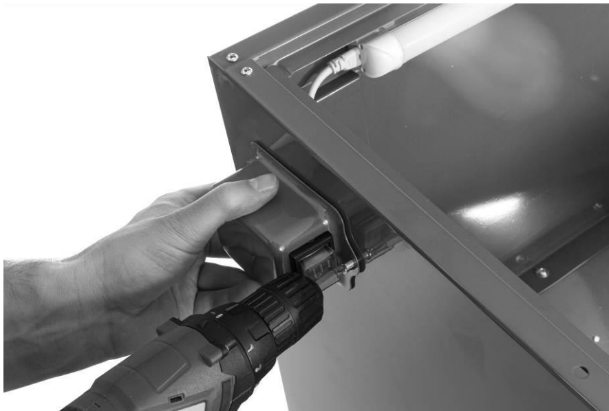
Figuur 11: Demontage van de bekistingsdoos
