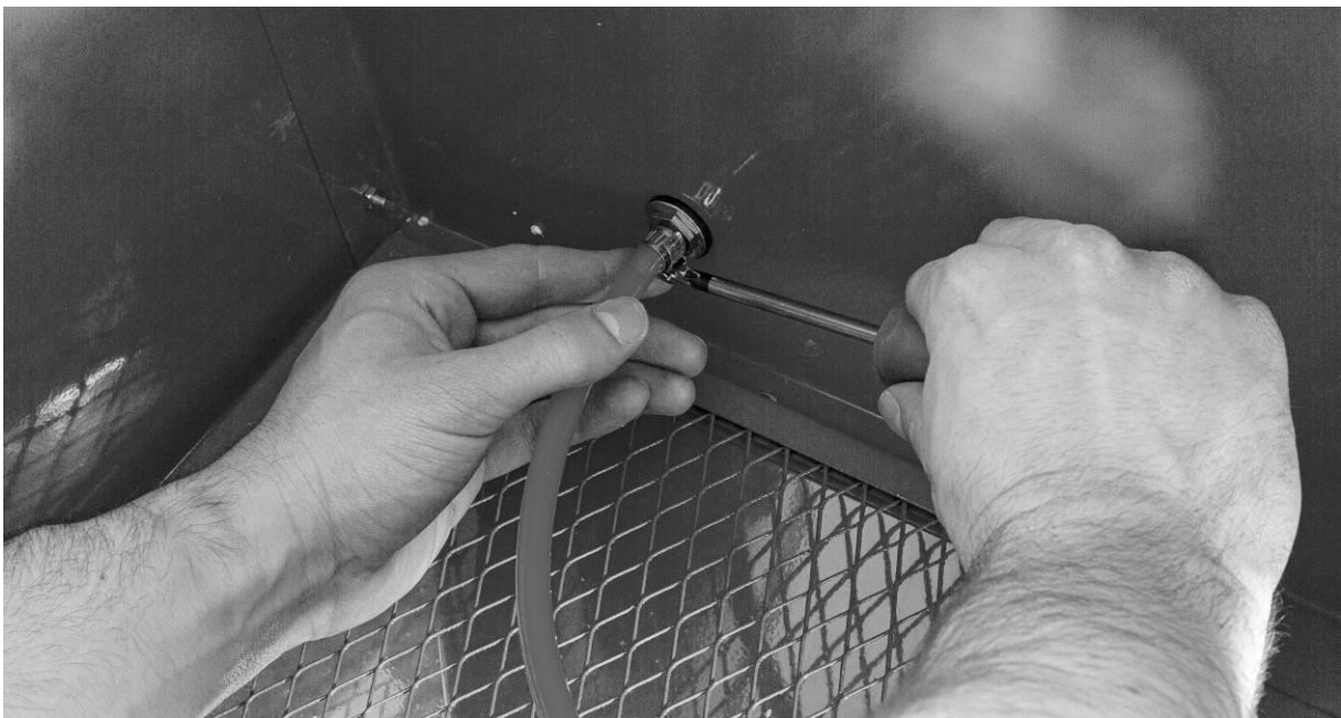
Figuur 22: Bevestiging van de dunne slang aan de inlaat van de perslucht in de zandstraalcabine
