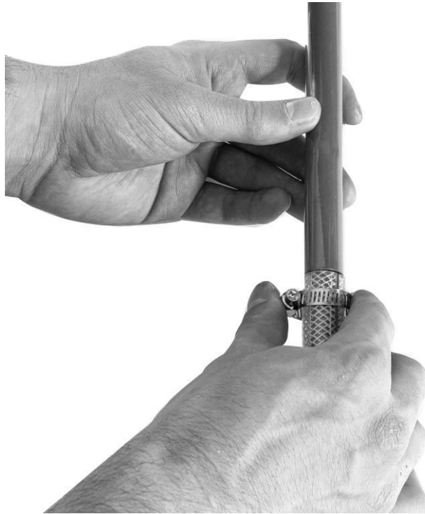
Figur 19: Fäst den tjocka slangen på metallröret
