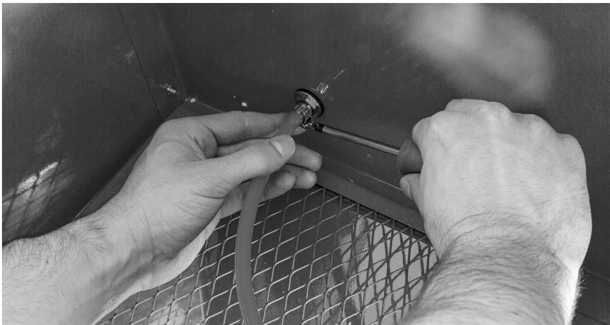
Obrázok 22: Pripevnenie tenkej hadice k vstupu stlačeného vzduchu vo vnútri pieskovacej kabíny
