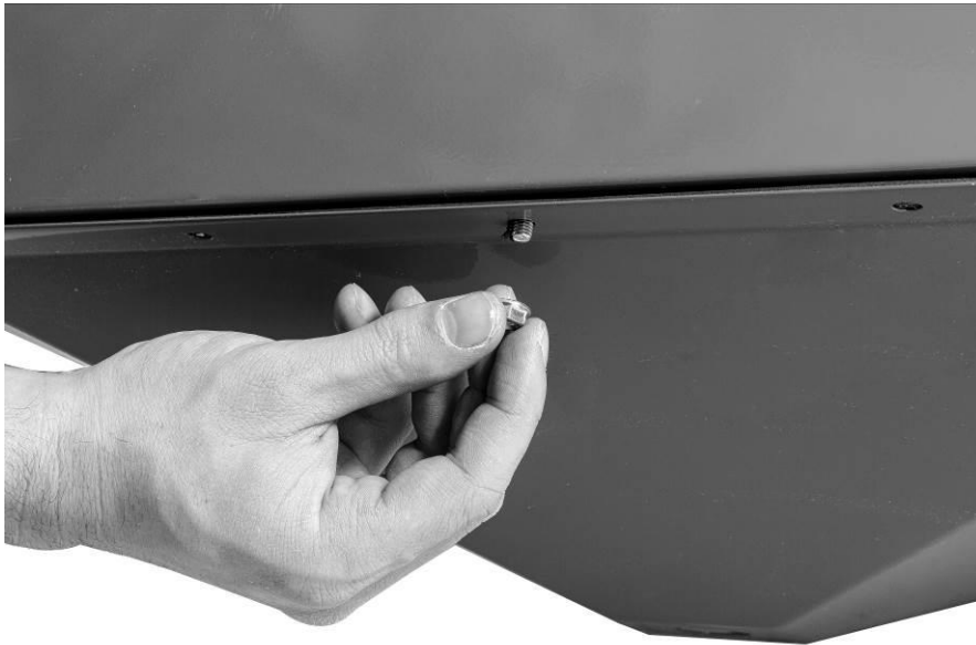
Obrázok 6: Upevnenie matice k spodnej časti pieskovacej kabíny
