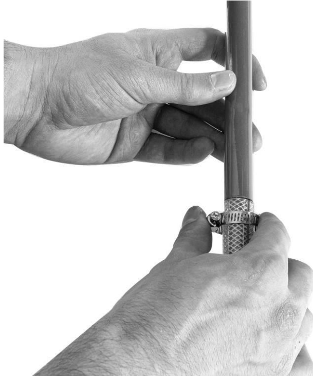
Obrázok 19: Upevnenie hrubej hadice na kovovú rúrku
