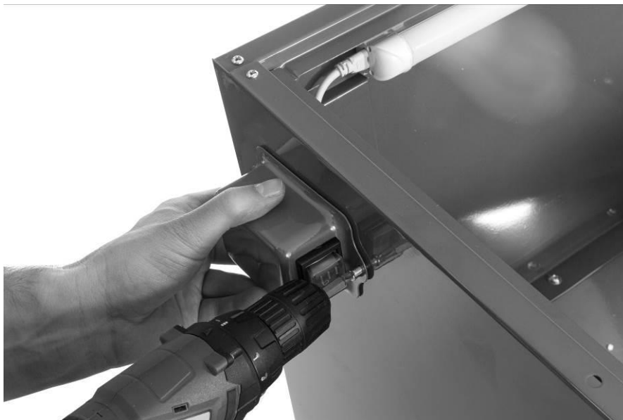
Obrázok 11: Demontáž debniacej skrinky
