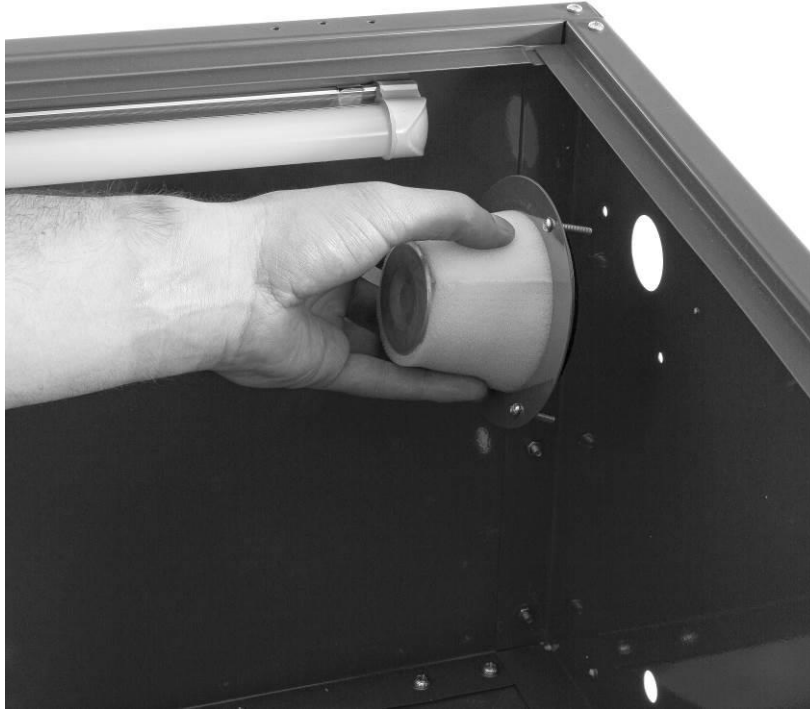
Obrázok 17: Montáž penového filtra
