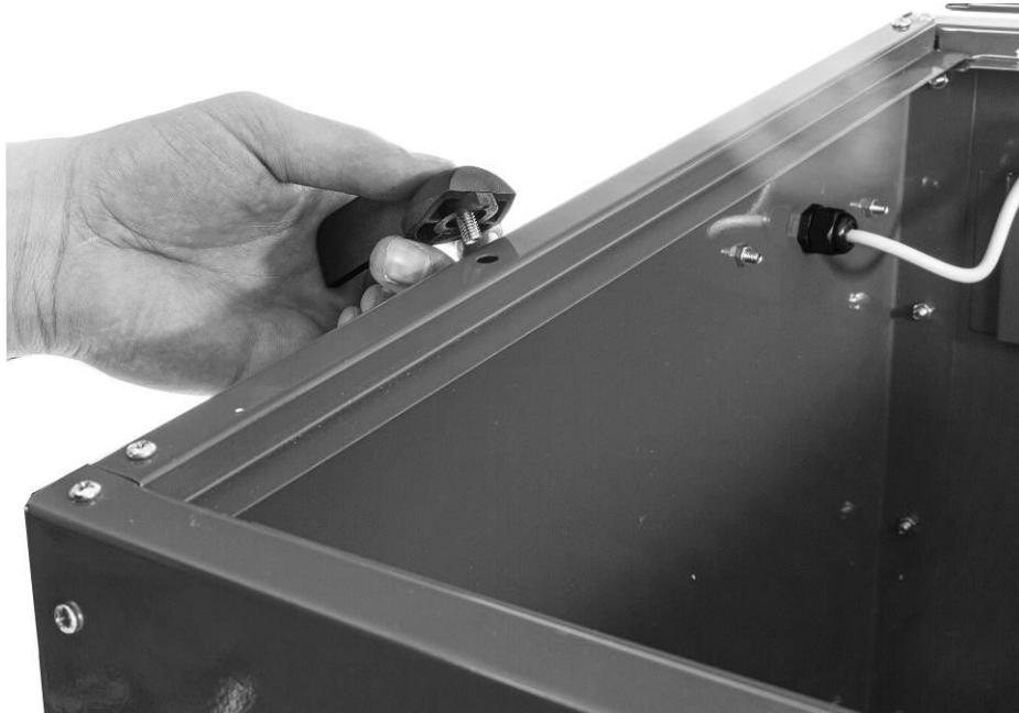
Obrázok 27: Upevnenie pák na zatváranie
