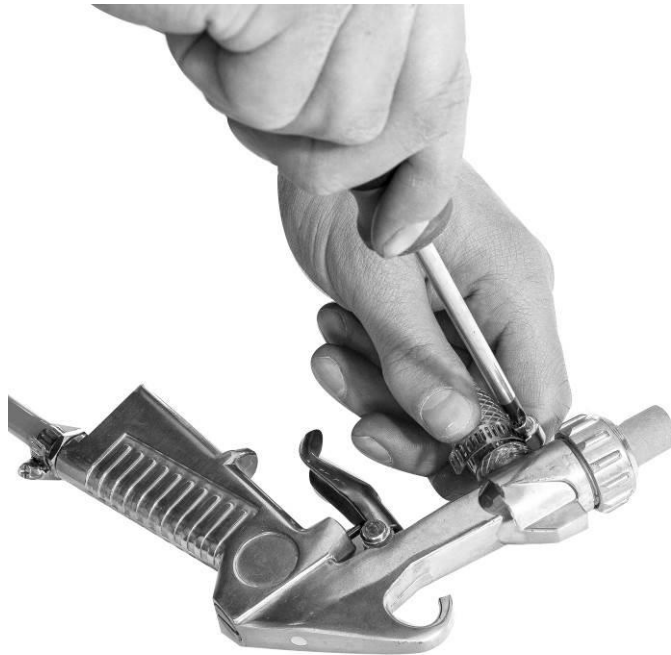
Obrázok 18: Pripevnenie hrubej hadice k pieskovacej pištole
