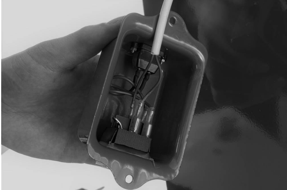
Obrázok 15: Pripojenie kábla k spínaču
