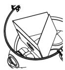
• Bringen Sie den Deckel des Staubsaugers auf dem Sammelbehälter an und sichern Sie ihn mit den Haken.
