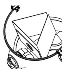
• Bringen Sie den Deckel des Staubsaugers auf dem Sammelbehälter an und sichern Sie diesen mit dem Haken.
