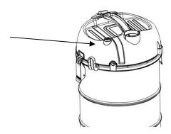
• Lösen Sie den Haken und heben Sie den Deckel des Staubsaugers an.
